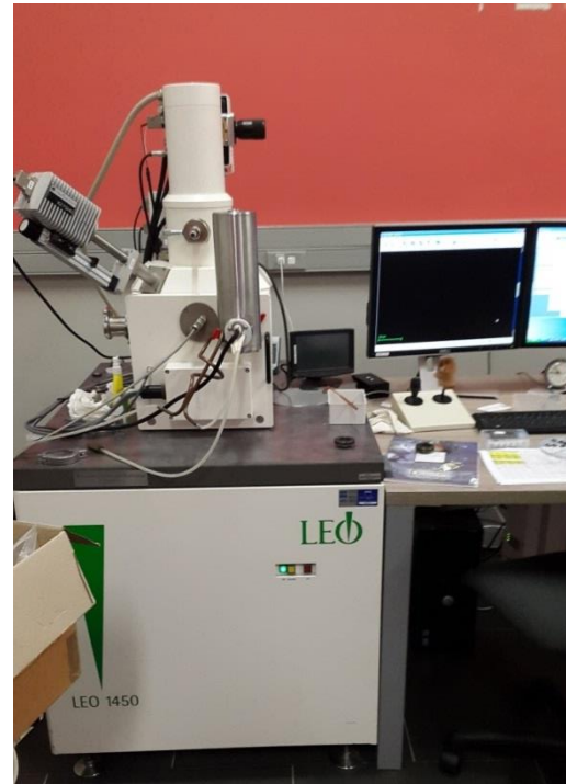
Figura 7 – SEM con detector RX , LEO 1450
