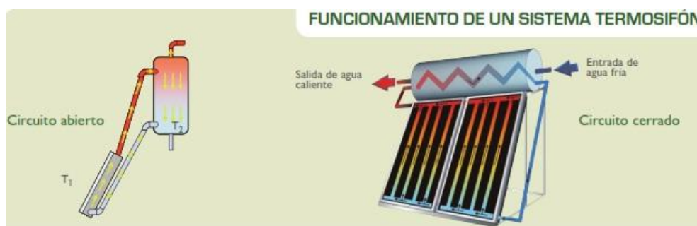
Figura 8: Sistema de termosifón
