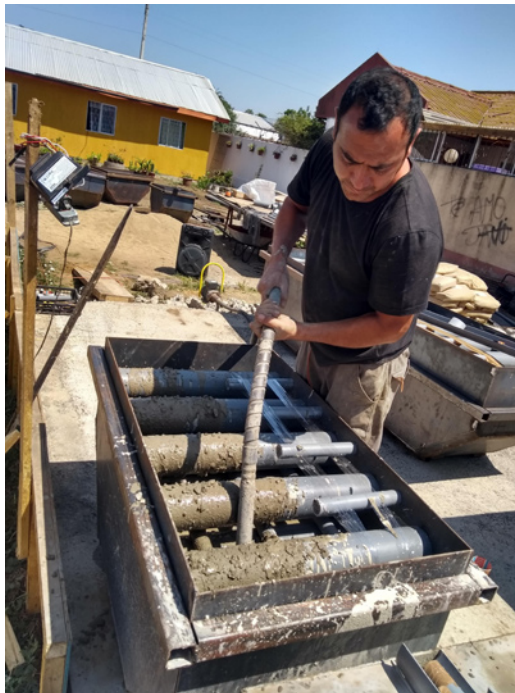
Figura 2.10. Vibrado de la mezcla en molde con vibrador.
