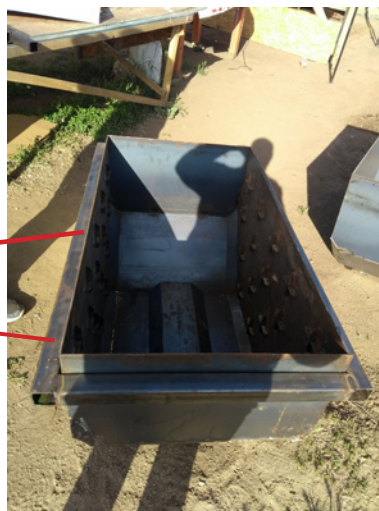
Figura 2.6. Molde con candado, preparado para instalar las tuberías.
